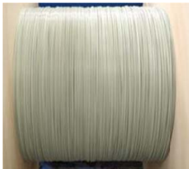
ภาพประกอบที่ 3.6 KFRP/AFRP รูปแบบแกนตันที่ใช้รับแรงดึงในสายเคเบิลสื่อสาร
