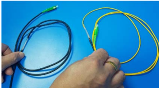
ภาพประกอบที่ 3.27 ทดลองเชื่อมต่อสายต้นแบบ New Access OFC V.4 กับสาย OFC ที่เกี่ยวข้อง
