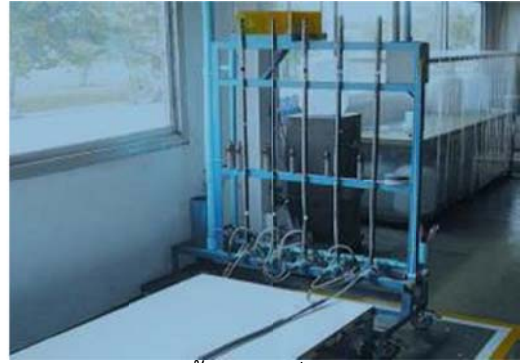
ภาพประกอบที่ 2.26 ตัวอย่างอุปกรณ์ทดสอบการซึมผ่านของน้ำและเครื่องมือทดสอบฯ
