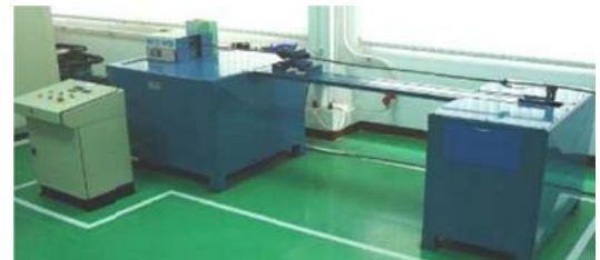
ภาพประกอบที่ 2.27 ตัวอย่างอุปกรณ์ทดสอบแรงบิดและเครื่องมือทดสอบแรงบิด
