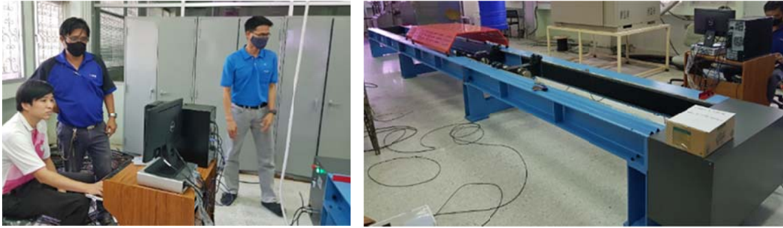
ภาพประกอบที่ 3.15 ทดสอบการรับแรงดึงสาย New Access OFC V.3
