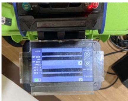
ภาพประกอบที่ 4.8 พื้นที่ บน.1.2 ทดลองเชื่อมต่อสาย New Access OFC ด้วยเครื่อง Fusion Splicer กับสายที่ใช้ในโครงข่าย ODN
