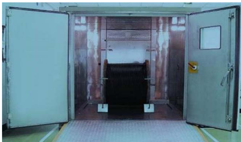
ภาพประกอบที่ 2.30 แสดงเครื่องมือทดสอบวัฏจักรอุณหภูมิ (ตู้ควบคุมอุณหภูมิ)
