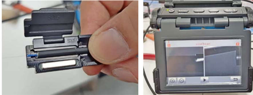
ภาพประกอบที่ 3.21 วางเส้นใยแก้วนำแสงกับ Holder 3.50 mm และภาพจากเครื่อง Fusion Splicer
