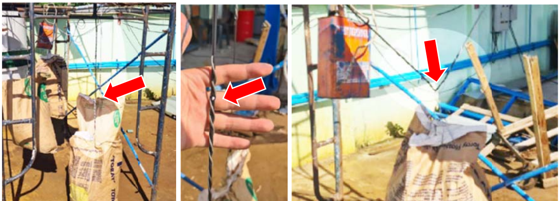
ภาพประกอบที่ 3.36 ทดสอบแรงกระทำคงที่ต่อเนื่องอุปกรณ์จัดยึด Preformed และ Tangent
