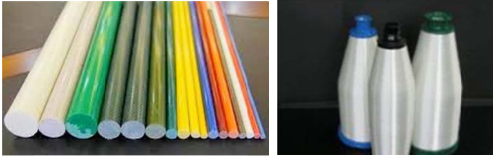
ภาพประกอบที่ 3.5 วัสดุรับแรงดึง GFRP
